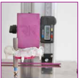
Ermittlung µm-genaue Messwerte zum Abgleich der lagegenauen Position der Durchtrittsöffnung im Prüfprotokoll
